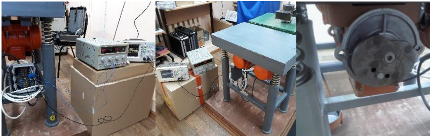
Рис. 5. Экспериментальная установка для исследования потерь мощности при пуске неуравновешенных электродвигателей на едином основании
