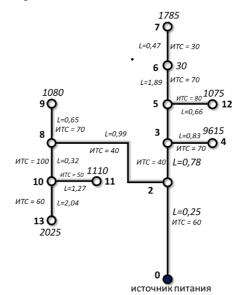
Рис. 2. Взвешенный граф участка распределительной сети 6(10) кВ
