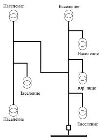
Рис. 1. Пример участка распределительной сети 6(10) кВ
