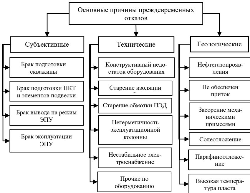
Рис. 3. Основные причины преждевременных отказов в работе ЭПУ и ПЭД
