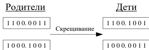
Рис. 3. Процесс скрещивания переменных в двоичной системе исчисления
