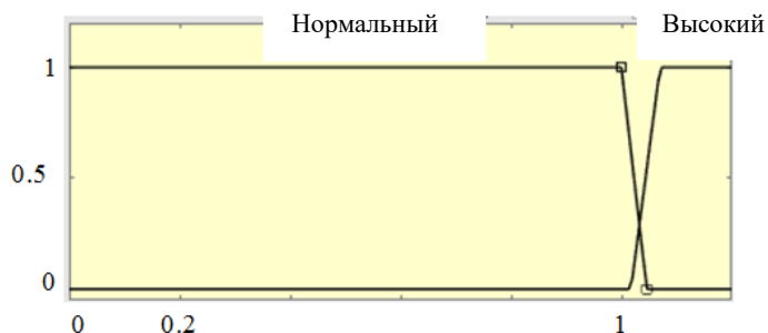
Рис. 2. Функции принадлежности лингвистической переменной «Выходной ток ПЧ»
