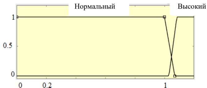
Рис. 3. Функции принадлежности лингвистической переменной «Температура ключей»
