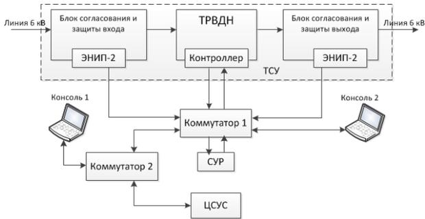
Рис. 7. Функциональная схема СУ 2 ЭО ТРН
