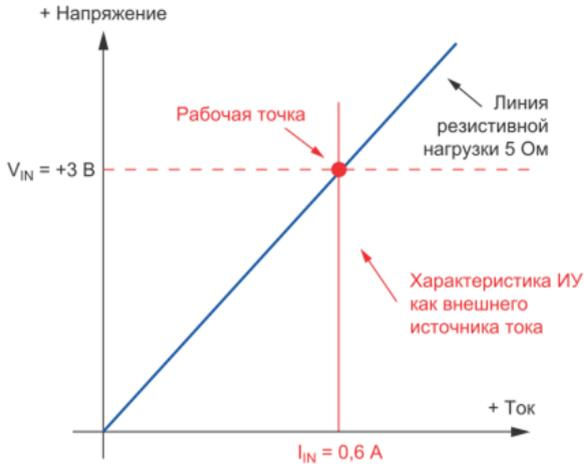
Рис. 6. ВАХ электронной нагрузки в режиме постоянного сопротивления
