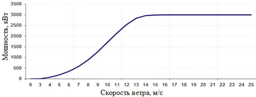
Рис. 2. Зависимость мощности турбины V90 3,0 МВт от скорости ветра
