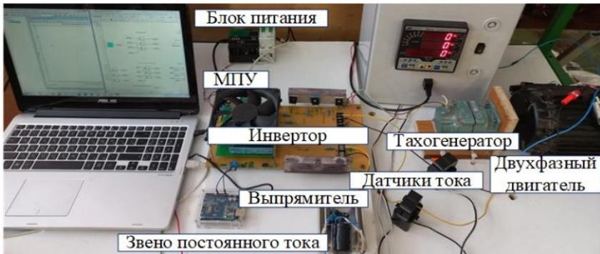
**Рис. 3. Внешний вид экспериментальной установки**
