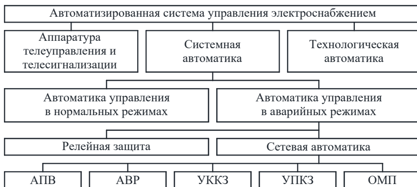
Рис. 1. Структурная схема АСУЭ железных дорог
