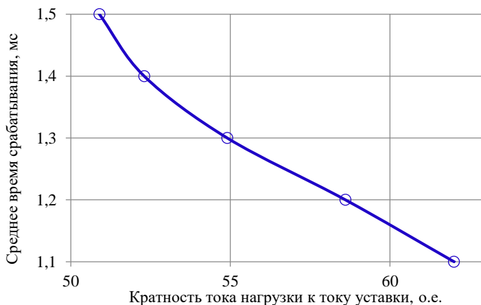
Рис. 12. Зависимость среднего времени срабатывания от кратности тока нагрузки
