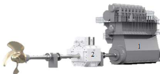
Рис. 1. Судовая гибридная дизель-электрическая пропульсивная установка:
