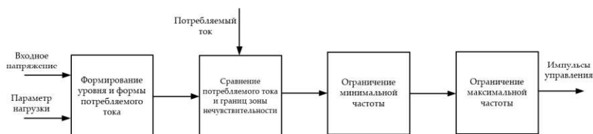
Рис. 3. Структурная схема, поясняющая принцип работы модифицированного релейного способа
