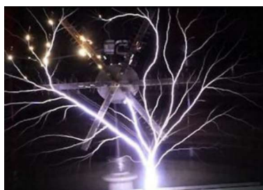
Рис. 7. Предполагаемый результат разветвленных разрядов СЭ в виде «дерева» на поверхности диэлектрика
