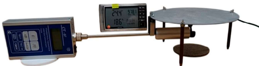
Рис. 4. Размещение наэлектризованного образца диэлектрика под заземленной плоскостью измерителя электростатического поля ротационного типа
